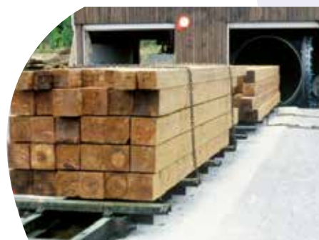
Procédé de traitement des bois par autoclave
